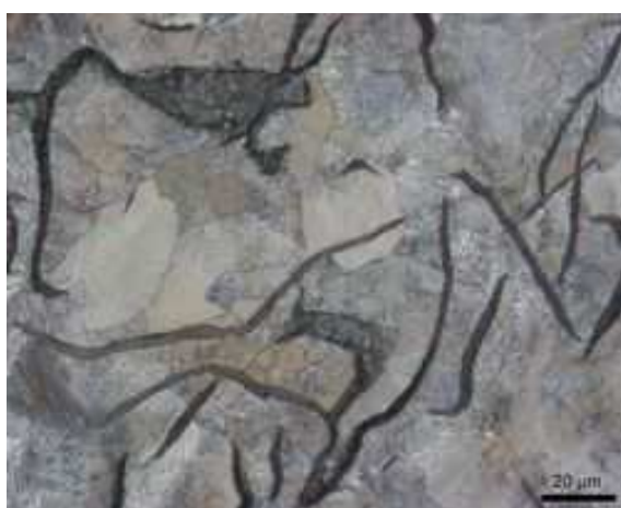
Obr. 3.2 Litina s lupínkovým grafitem s maticí perlitickou (8)
