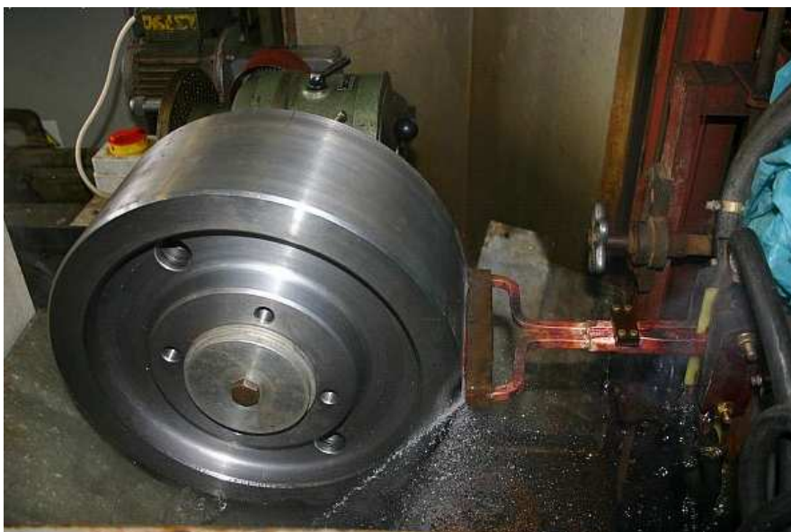
Obr. 3.9 Středofrekvenční povrchové kalení (17)
