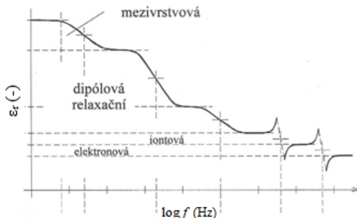
Obr. 2.8: Příspěvky jednotlivých polarizací k relativní permitivitě v závislosti na frekvenci[1]
