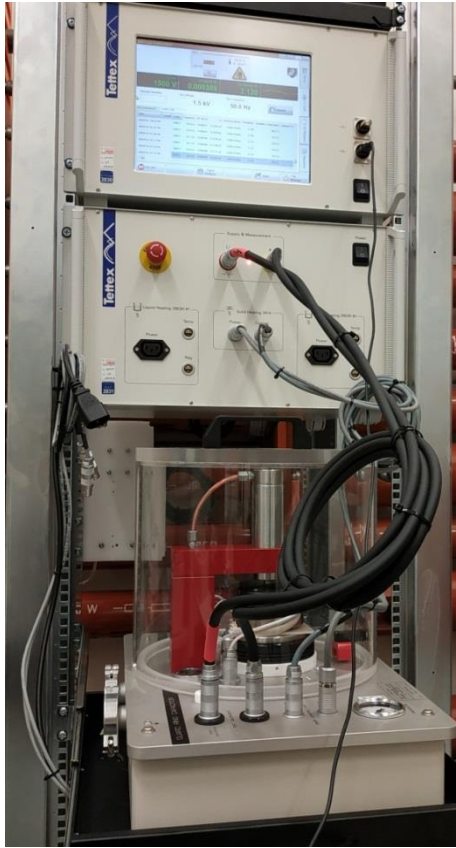
Obr. 5.8: Zapojení soustavy pro měření pevných dielektrik
