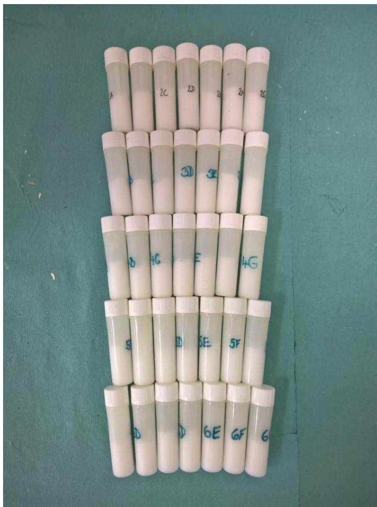
Obr. E-1: Připravené aktivační detektory pro šachty č. 2 až č. 6
