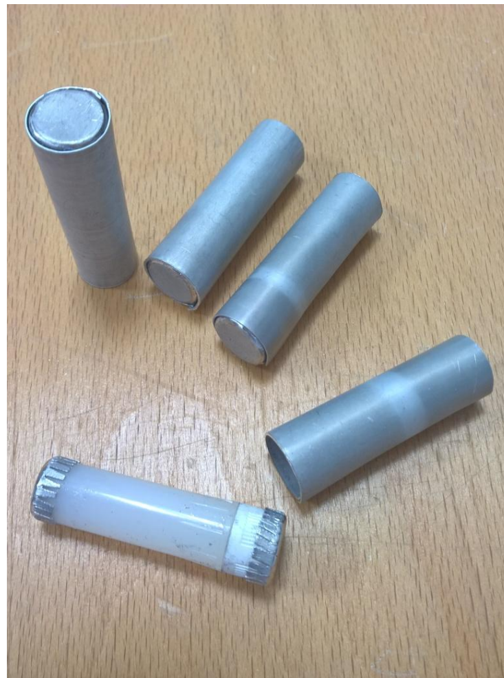
Obr. E-4: Vyrobené kadmiové pokrytí aktivačních detektorů
