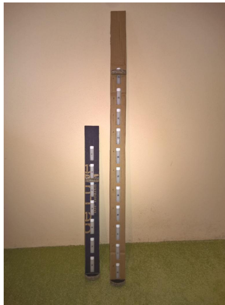
Obr. E-2: Porovnání krátkého a dlouhého držáku aktivačních detektorů
