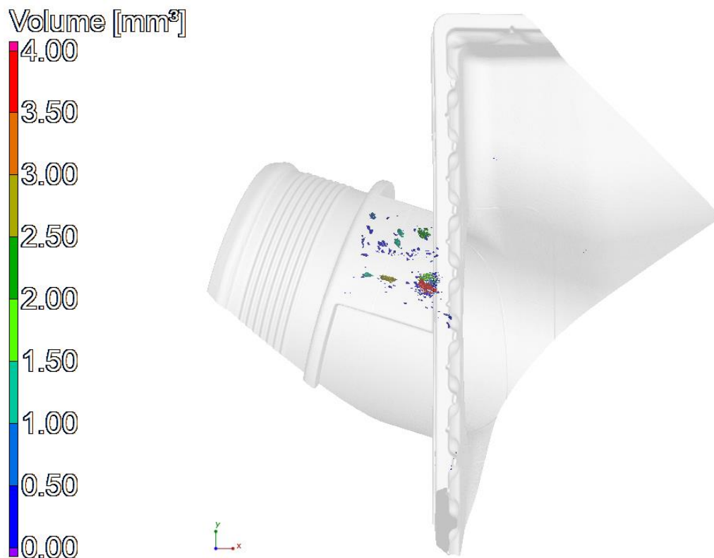
Obr. 49: Vizualizace distribuce lunkrů ve skenu s voxelovým rozlišením 62 \mu\text{m} . Lunkry jsou barevně označeny na základě jejich objemů.
