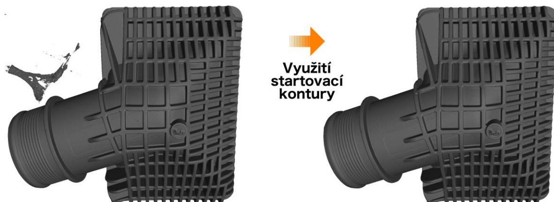
Obr. 36: Zobrazení odfiltrování nečistot v naskenovaných datech výrobku Cog Wheel č.5. Vlevo - povrch s nečistotami určený pomocí funkce isovalue based; vpravo - povrch určený za pomoci startovací kontury a hledání povrchu v jejím okolí.
