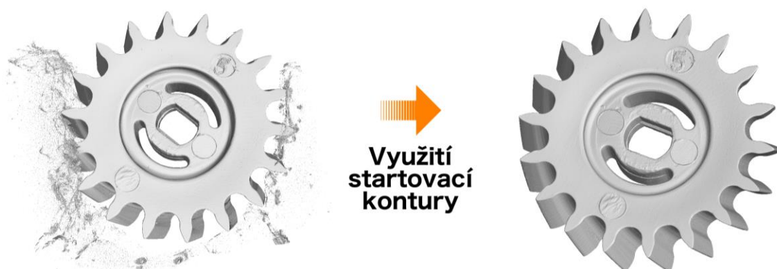
Obr. 26: Zobrazení odfiltrování nečistot v naskenovaných datech výrobku Cog Wheel č.5. Vlevo - povrch s nečistotami určený pomocí funkce isovalue based; vpravo - povrch určený za pomoci startovací kontury a hledání povrchu v jejím okolí.
