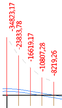
Obrázok 6.22: Pribeh momentov odpovedajúcich postaveniu pre maximálnu posúvajúcu silu v okolí podpory
