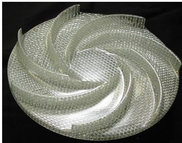
Obr. 16 Model s hexagonálnou výplňou [39]
