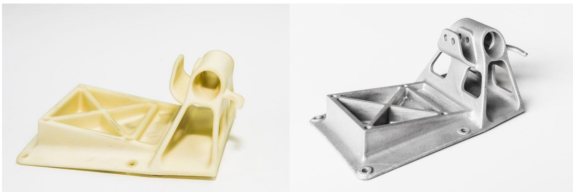
Obr. 23 Model z PMMA a následný odliatok [55]
