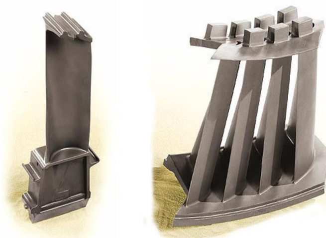
Obr. 3 Lopatky turbíny vyrobené presným odlievaním [7]
