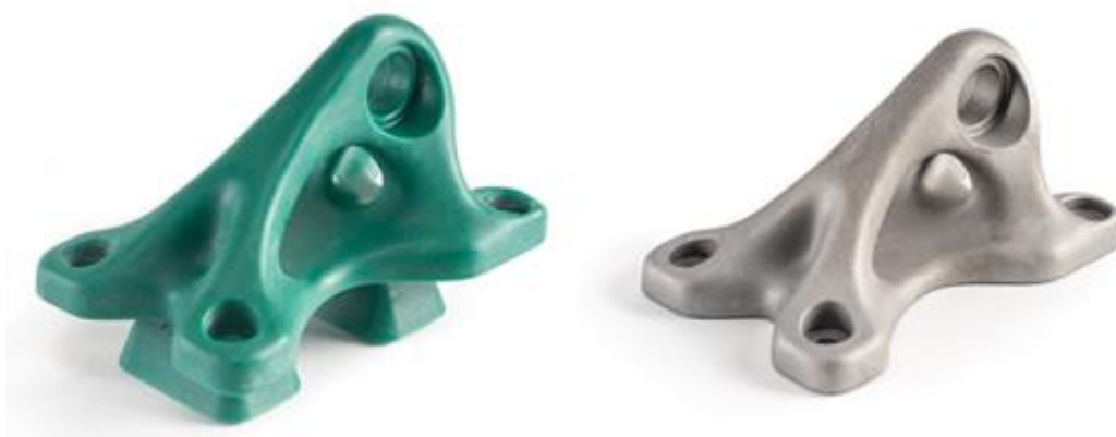
Obr. 14 Model topologicky optimalizovanej súčasti s odliatkom [35]
