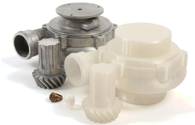
Obr. 9 Vytlačené modely a ich odliatky [25]
