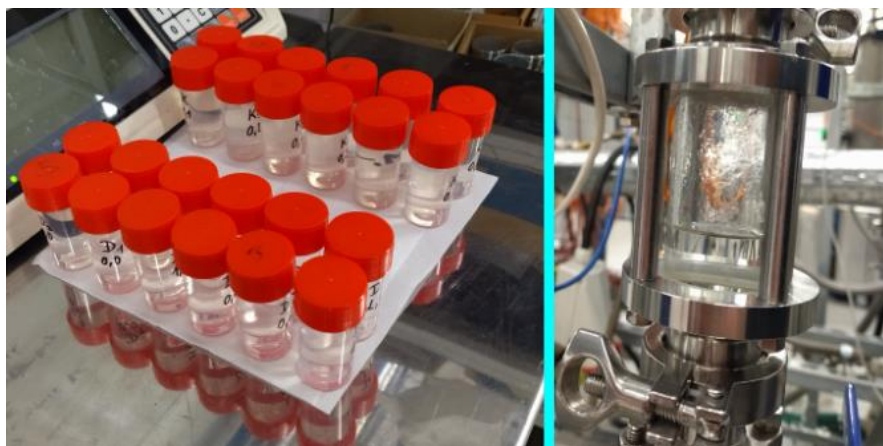
obr. 41: Vzorky (vlevo) a zásobník na odloučené kapky z cyklonu (vpravo)
