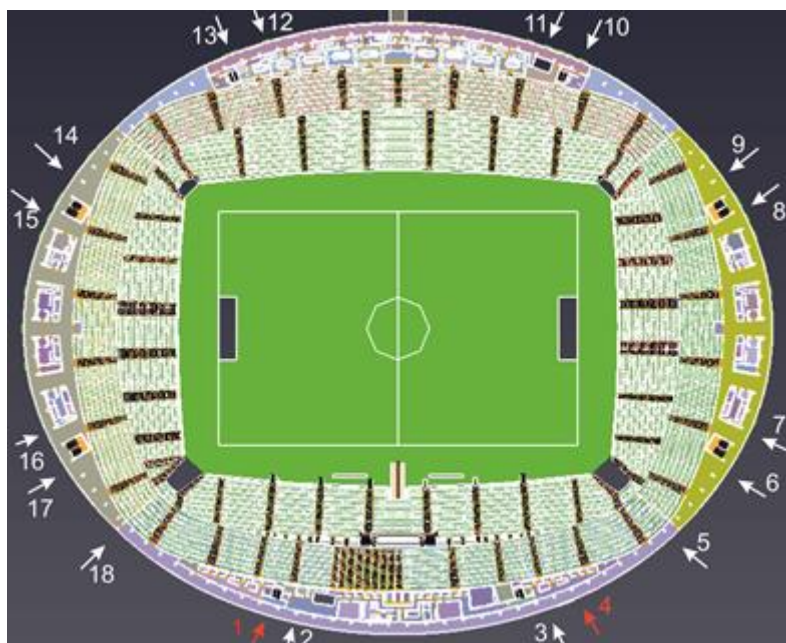
Obrázek 5.16 Varianta 2 - schéma únikových východů
