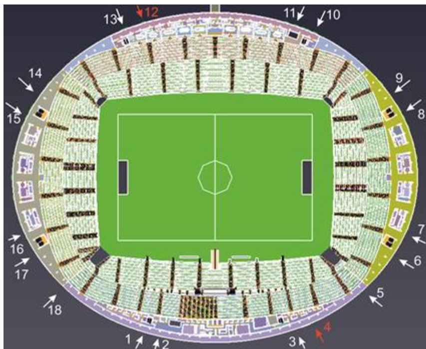
Obrázek 5.13 Varianta 1 - schéma únikových východů
