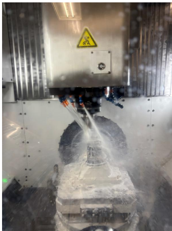
Obr. 28 Frézování základní kostky
