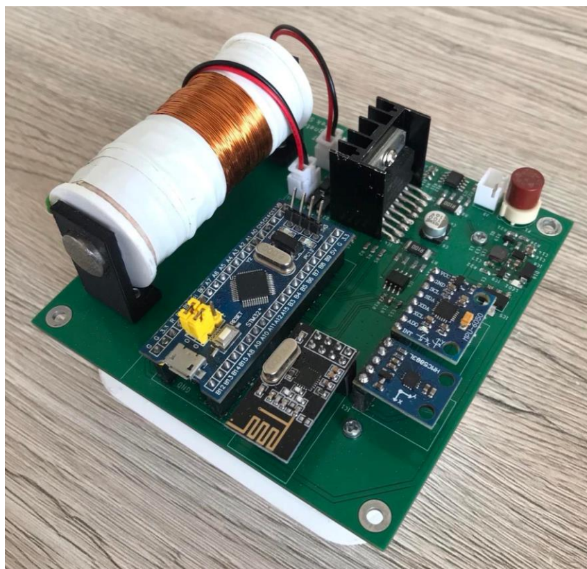
Obrázek 4.2: Testovací DPS s osazenými součástky, moduly a momentovými cívkami.
