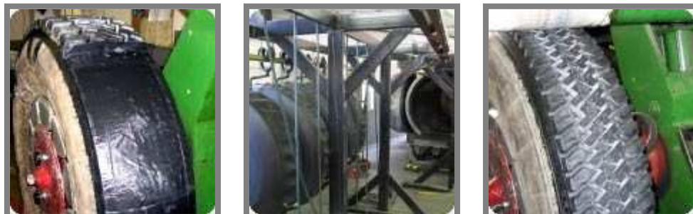
Obr.4 Protektorování „za studena“
