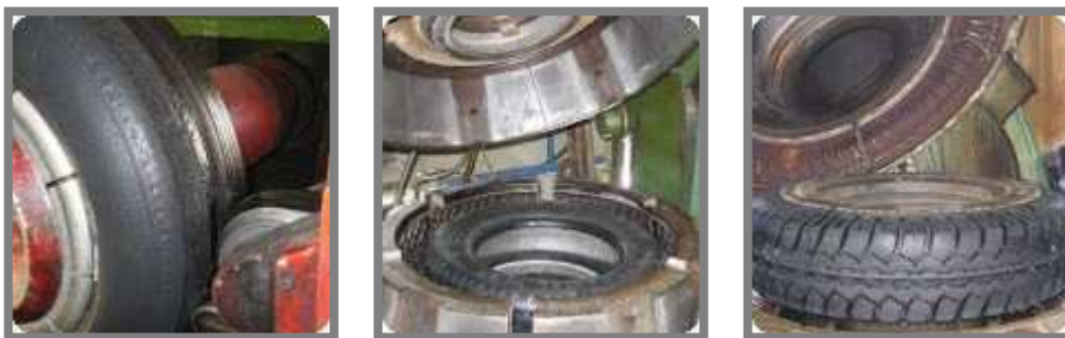
Obr.3 Protektorování „za tepla“
