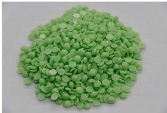
Obr. 12) Voskové granule pre presné liatie [35]
