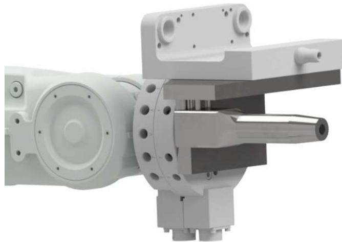
Obr. 34) Konvcový efektor s nahrievacou hlavou
