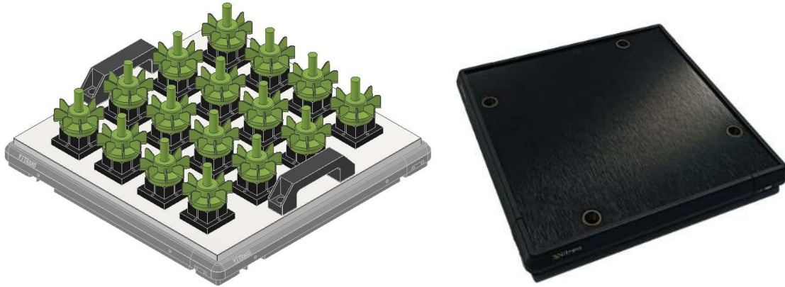
Obr. 36) Vľavo modeli na palete, Vpravo paleta WA2 [50]
