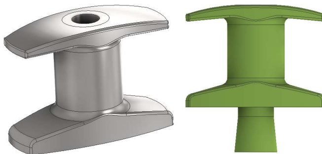
Obr. 25) V ľavo diel rúčka pred úpravou v pravo po úprave
