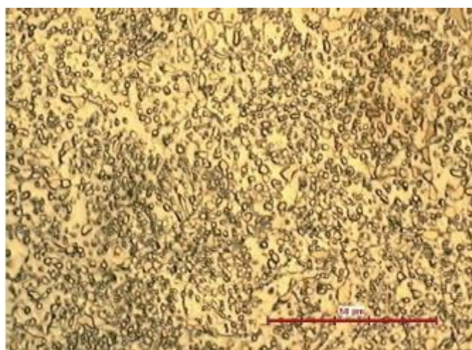
Obr. 33. Štruktúra po žíhaní na mätko (zv. 1000x) [5].
