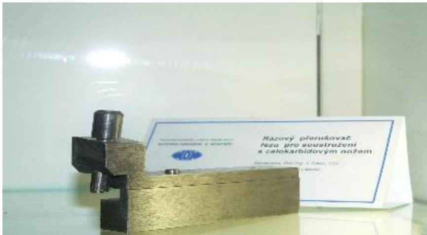
Obr. 16. Prerušovač rezu pre sústruženie s celokarbidovým nástrojom a manuálnym prerušením rázom [16].
