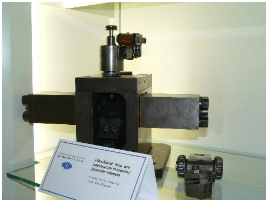
Obr. 17. Prerušovač rezu pre sústruženie spúšťaný tlakom plynu [16].
