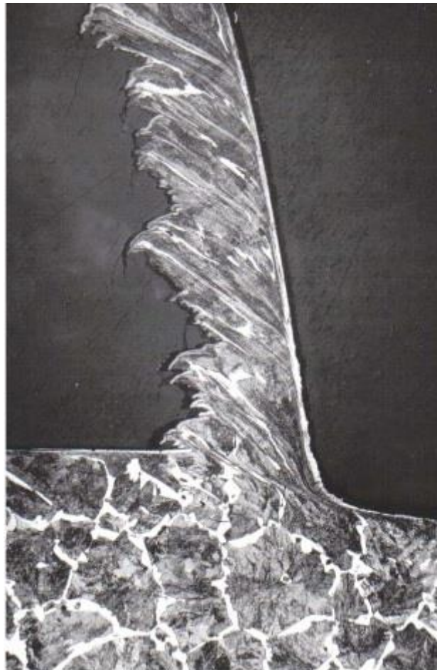
Obr. 12. Fotografia metalografického výbrusu koreňa triesky [15].
