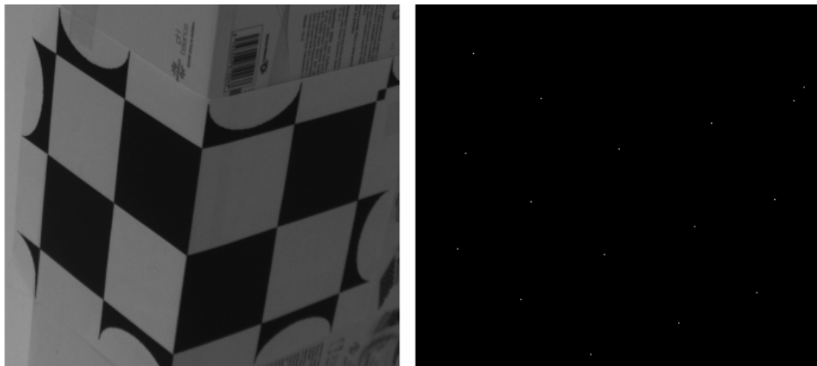
Obr. 28 Srovnání rozpoznávaných bodů kalibrační tabule
