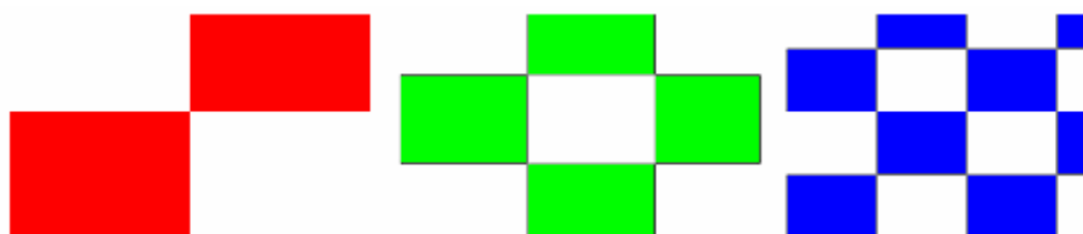
Obr. 22 První tři kroky měření s postupnou změnou rozlišení pro RGB kamery
