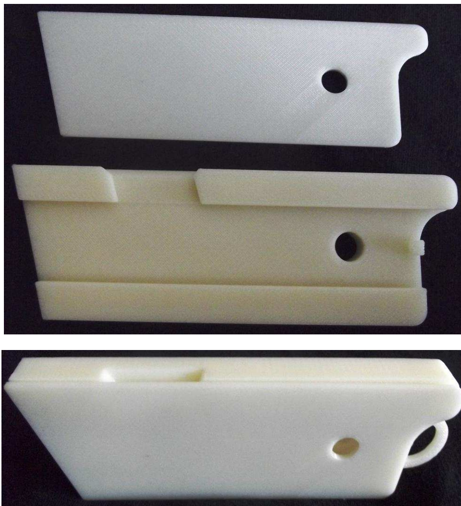
Obr. 3.15 Model vhazovače vyrobený technologií FDM.
