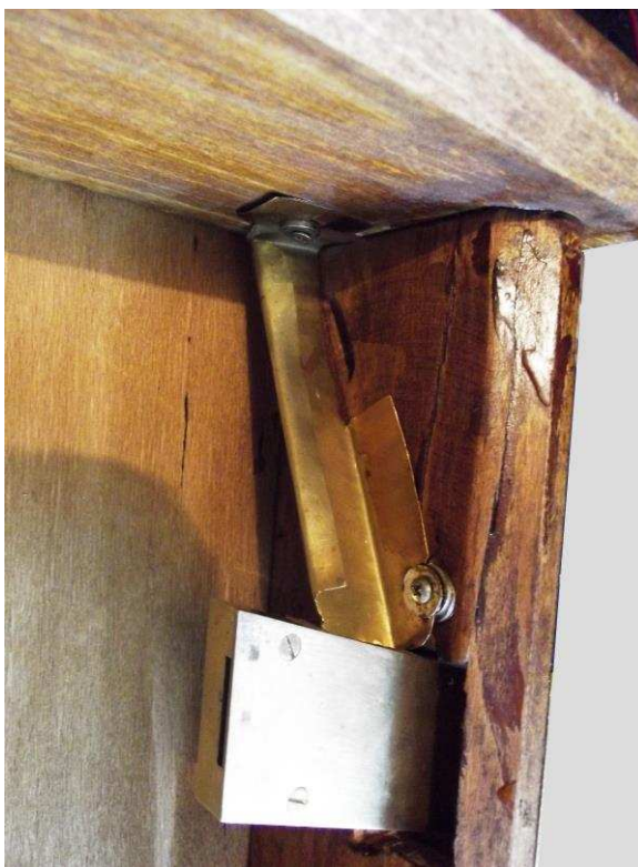
Obr. 3.17 Svod mincí do vhazovače mincí.
