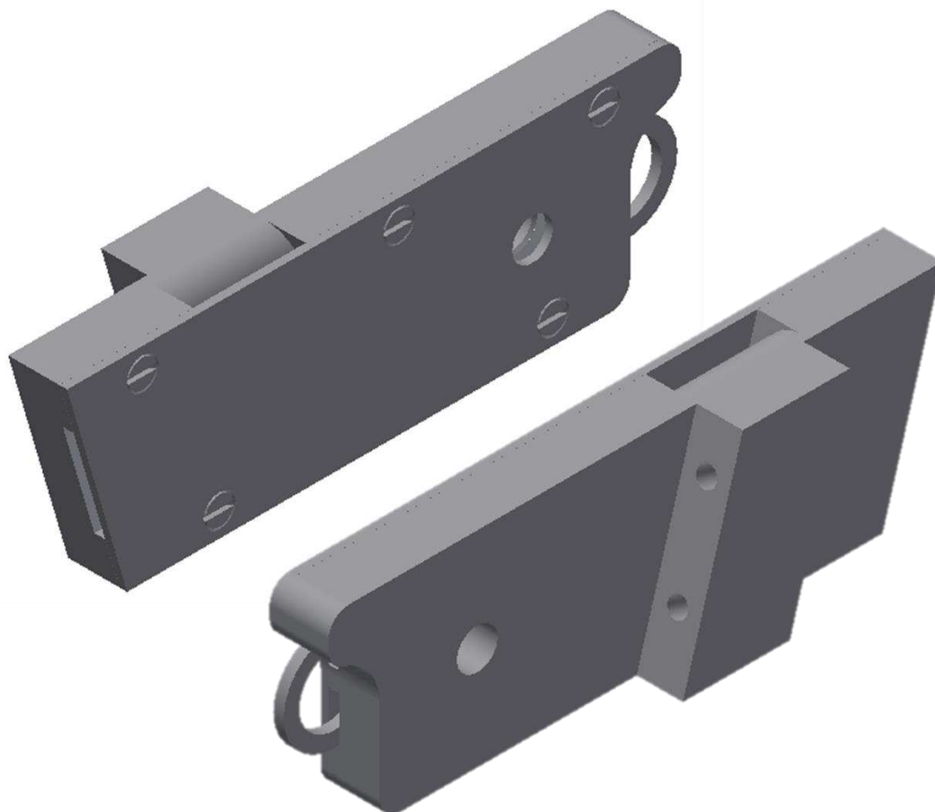
Obr. 3.14 Výsledný 3D model vhadzovače mincí.
