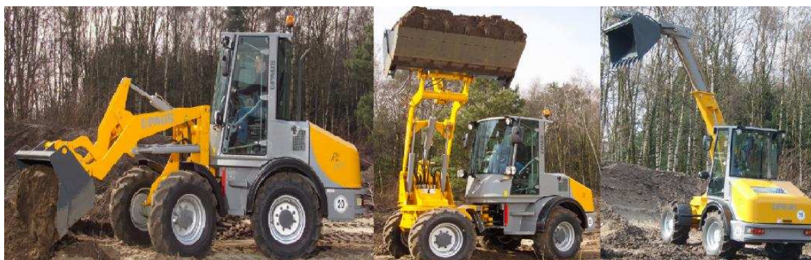
obr. 2 Jednotlivé typy výložníků, vlevo čelní, uprostřed otočný, vpravo teleskopický
