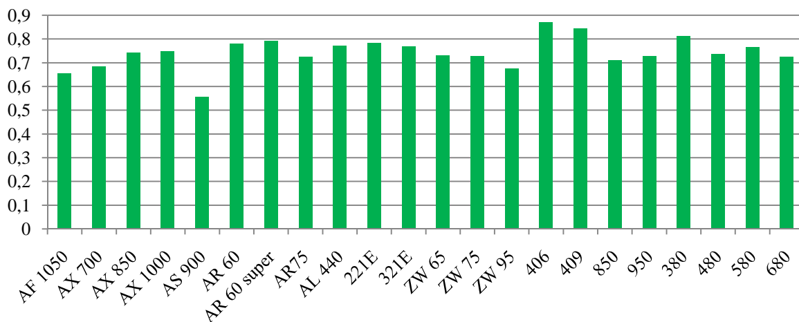
obr. 32 Druhé kritérium – poměr bodu přetížení a provozní hmotnosti
