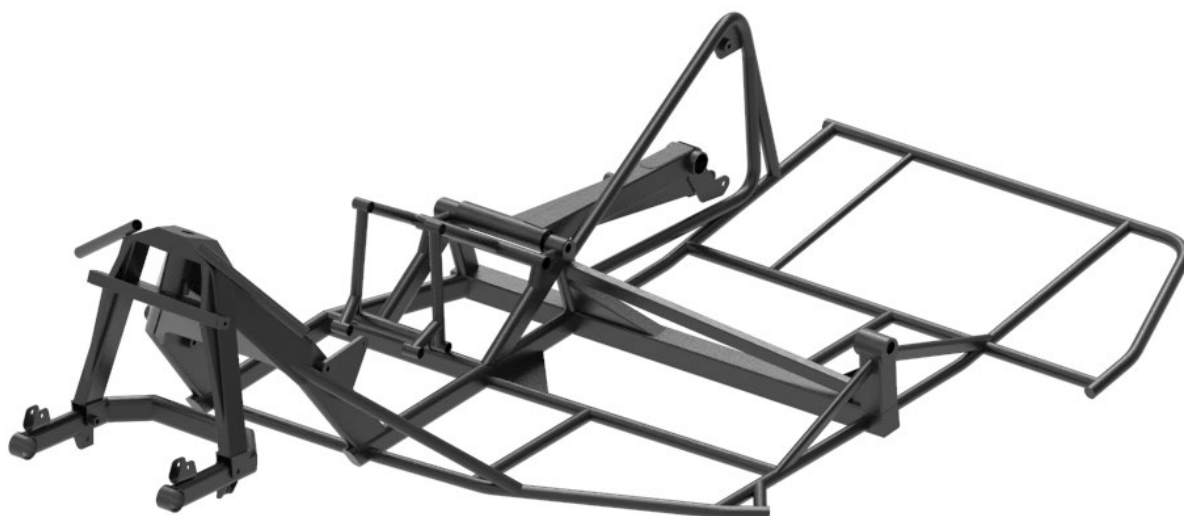
Obr. 18 3D model rámu sidecary s přední a zadní vidlicí
