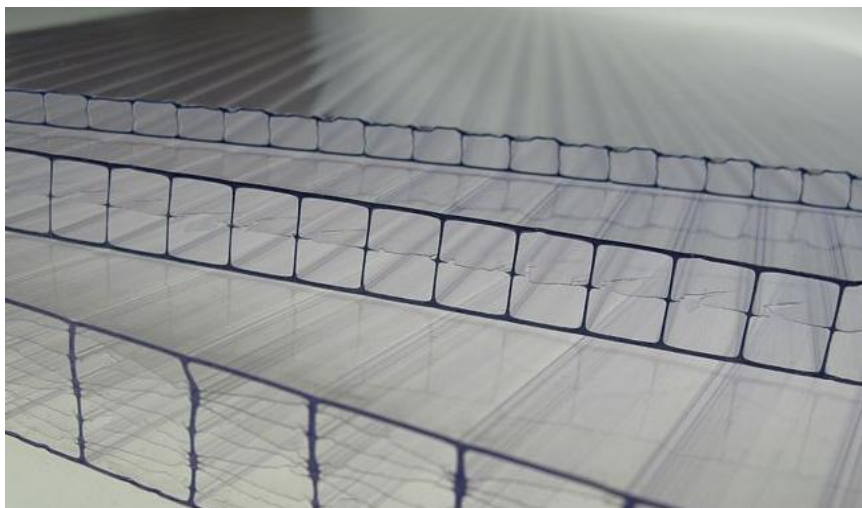
Obrázek 1 Struktura polykarbonátových desek [1].
