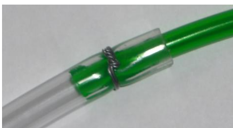
Obrázek 7 Zpevnění spoje dvou hadic za pomoci objímky z drátu.
