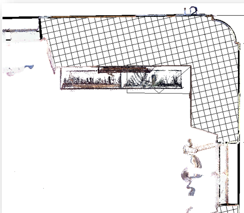
Obrázek 89 - Ukázka mračna bodů a jeho vektorizace [autor]
