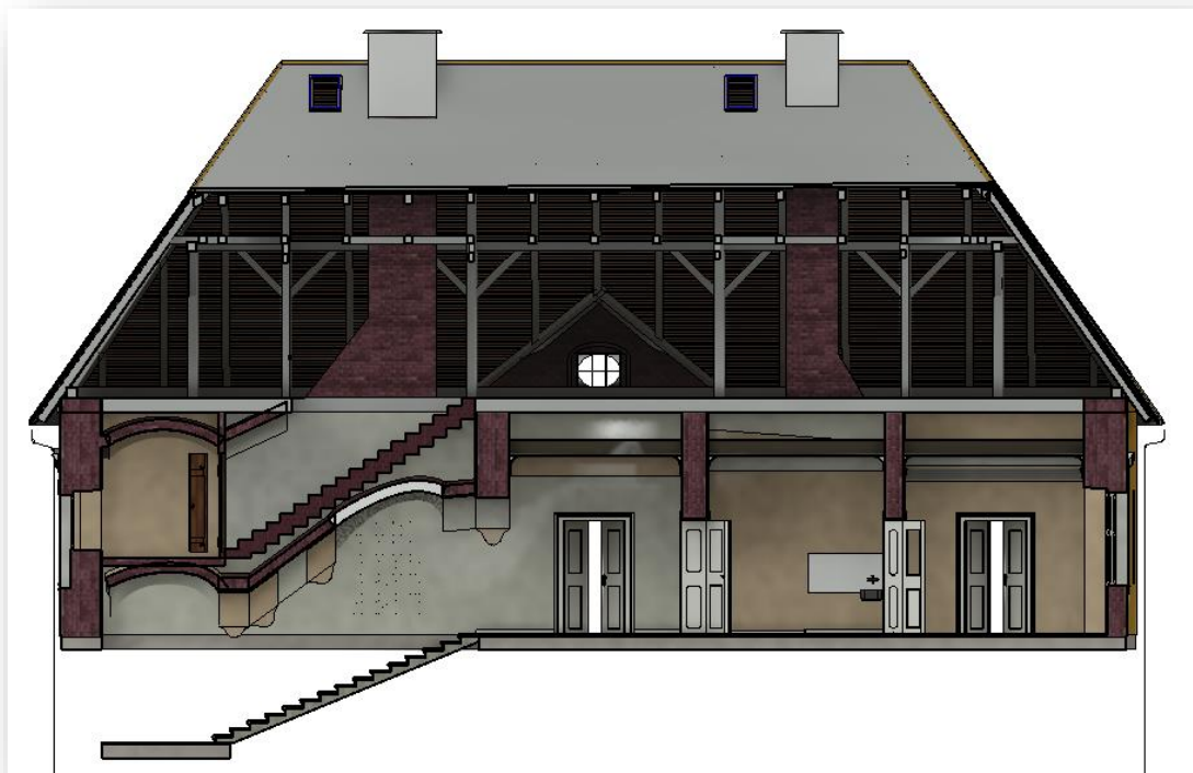
Obrázek 59 - Svislý řez 2.NP v programu Revit [autor]
