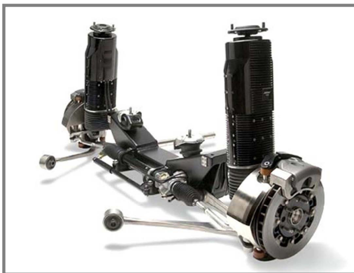
Obr. 1.2: Závěs BOSE s lineárními elektromotory
