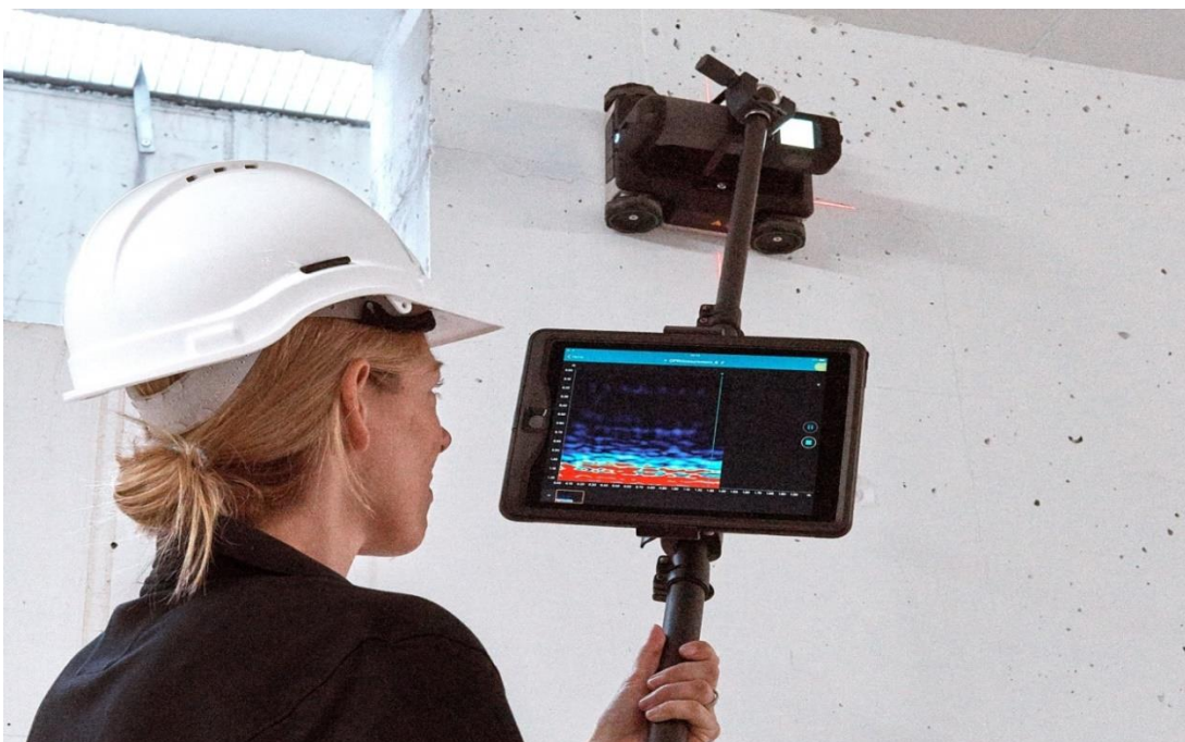
Obr. 2.3.4 – Proceq GPR Live na teleskopické tyči propojený s iPadem pro zobrazení měření [27].
