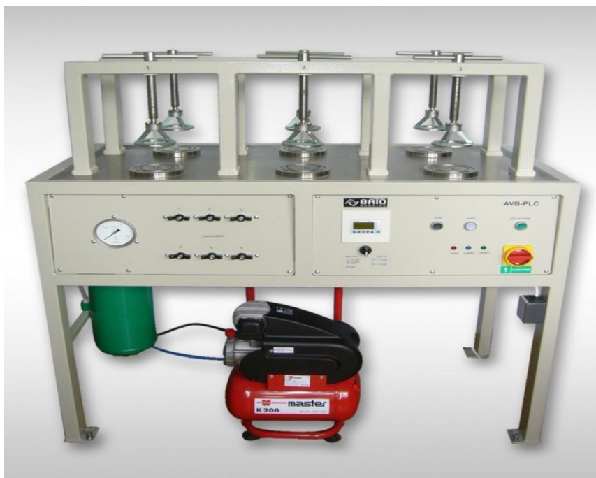
Obr. 2.3.1 – Zkušební stolice na zkoušky vodotěsnosti [22].
