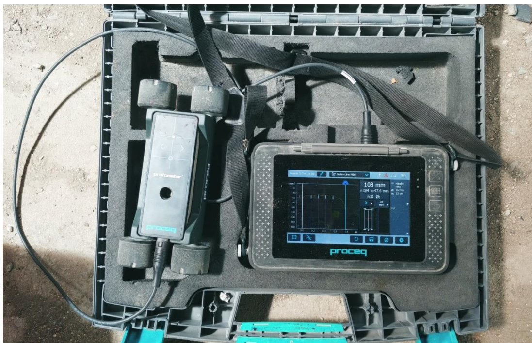
Obr. 2.3.5 – Profometer PM-630 od společnosti Proceq se zobrazením průběhu měření výztuže.
