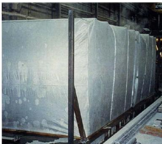
Obrázek 9: Propařování betonového prvku pod PE fólií [30]
