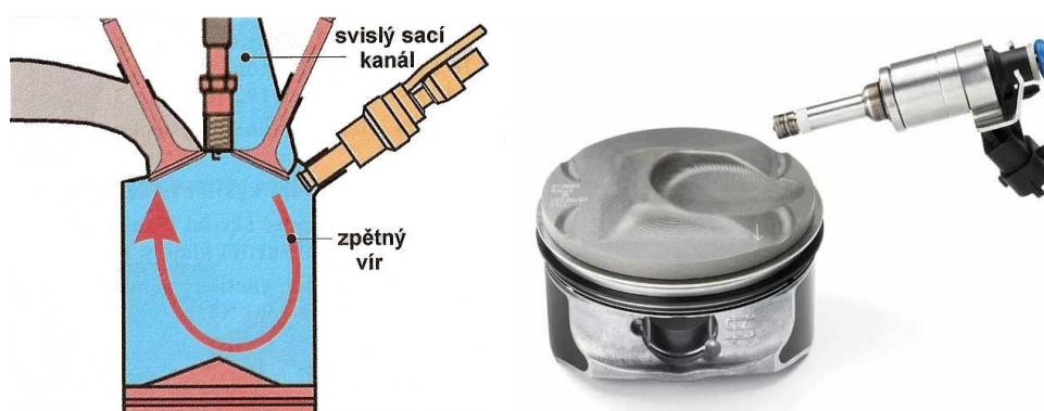
Obr. 5.1 – Přímé vstřikování GDI [1] a speciální konstrukce pístu GDI [10]
