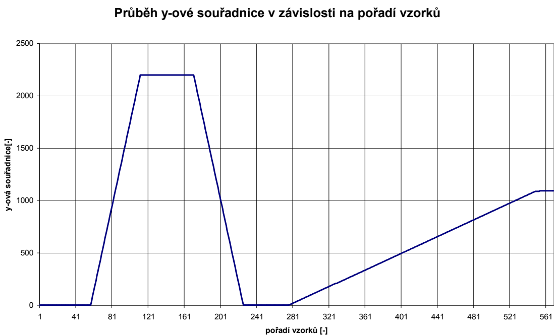
Obrázek 34: Posun senzoru v y-ové ose při vyhledávání optického svazku.
