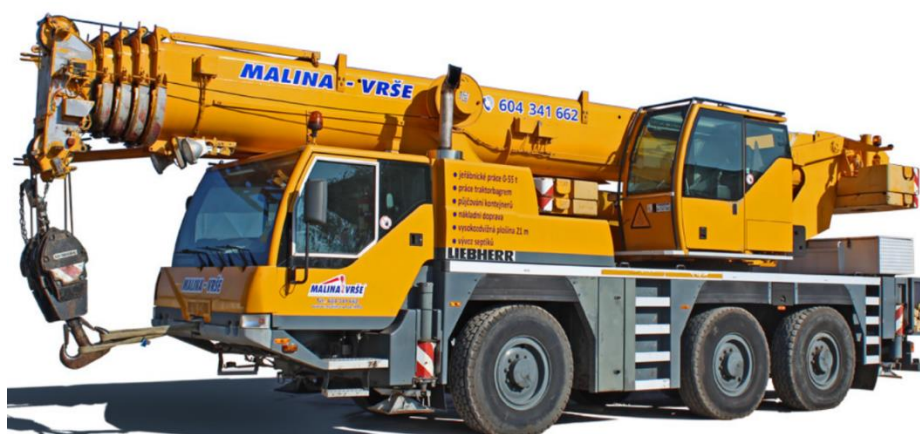
Obr. 38 Autojeřáb Liebherr LTM 50 [13]
