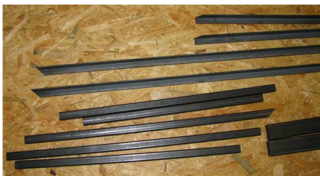
Obr. 7-12 Ocelové otevřené L a uzavřené čtvercové profily
