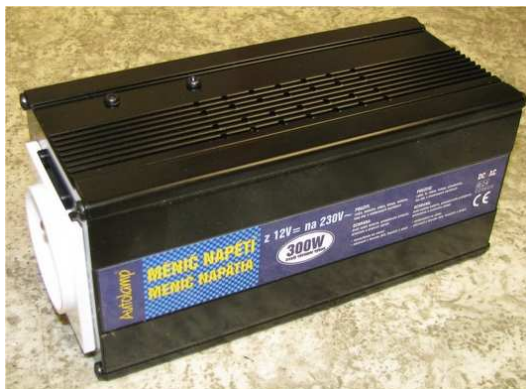
Obr. 7-19 Měnič napětí SP 300 12V/230V
