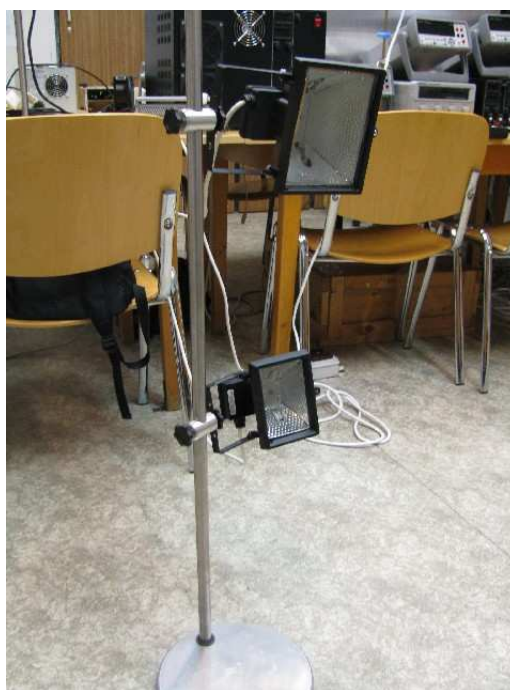
Obr. 9-1 Mobilní f_v systém a použité lampy v laboratorním prostředí
