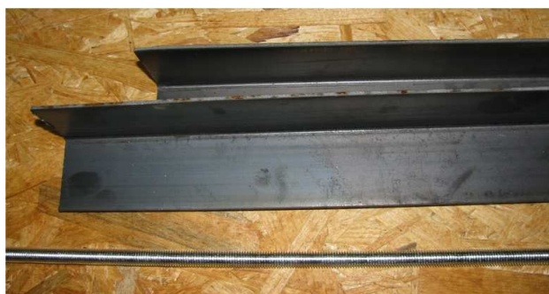
Obr. 7-6 Otevřený L profil, rovnoramenný a závitová tyč M10
