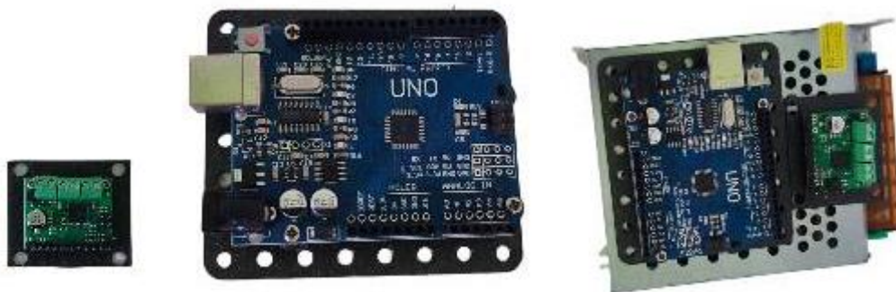
Obr. 6.4. Pripevnenie radiacích komponent na zdroj
