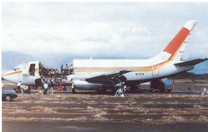
Obr. 3: Boeing 737-297 s odlomenou horní částí trupu. Trhlina se iniciovala vedle dveří za kabinou letounu.
