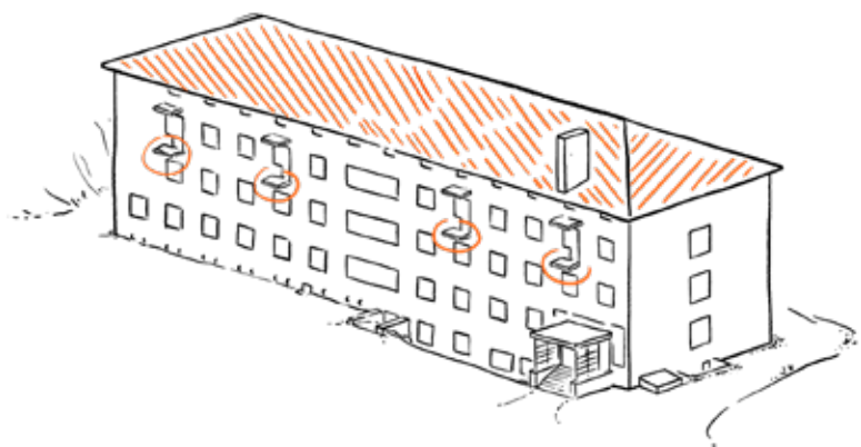
poškodená strecha a balkóny v havariínom stave
