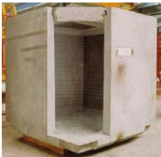
Obr. 22 – a) vláknobetonový kontejner, převzato a upraveno z [17], b) úložiště WIPP, převzato a upraveno z [17]
