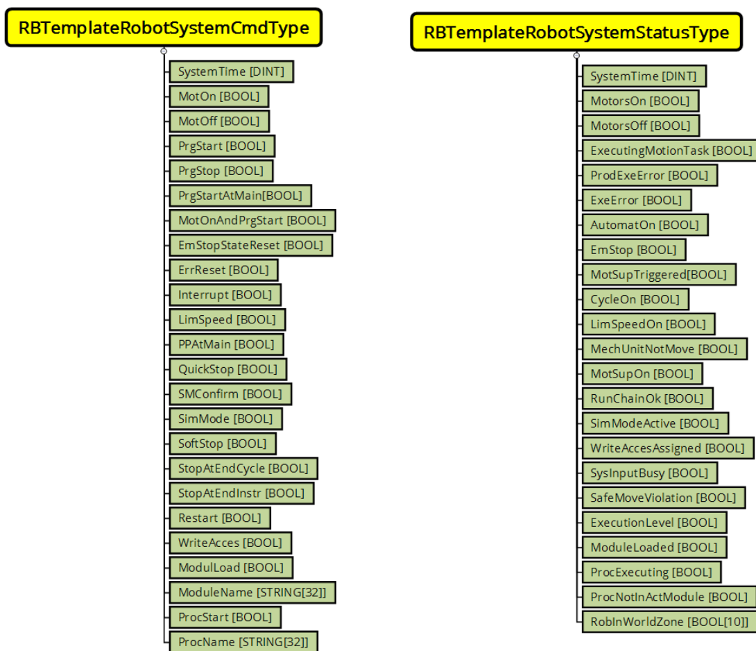
Obr. 5.3: Basic Modul – model komunikační struktury mezi APC a IRC5 (Příkazy statusy robota)
