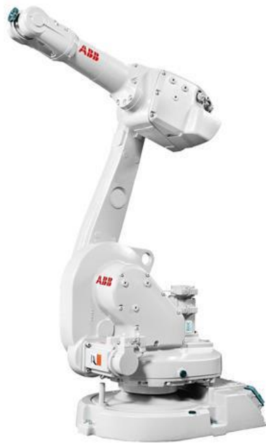
Obr. 3.3: Náhled stacionárního robota ABB IRB 1600 [12]
