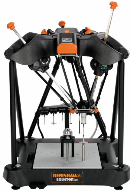
Obr. 3.2: Měřicí stanice Renishaw Equator 300 se sondou SP 225 [15]
