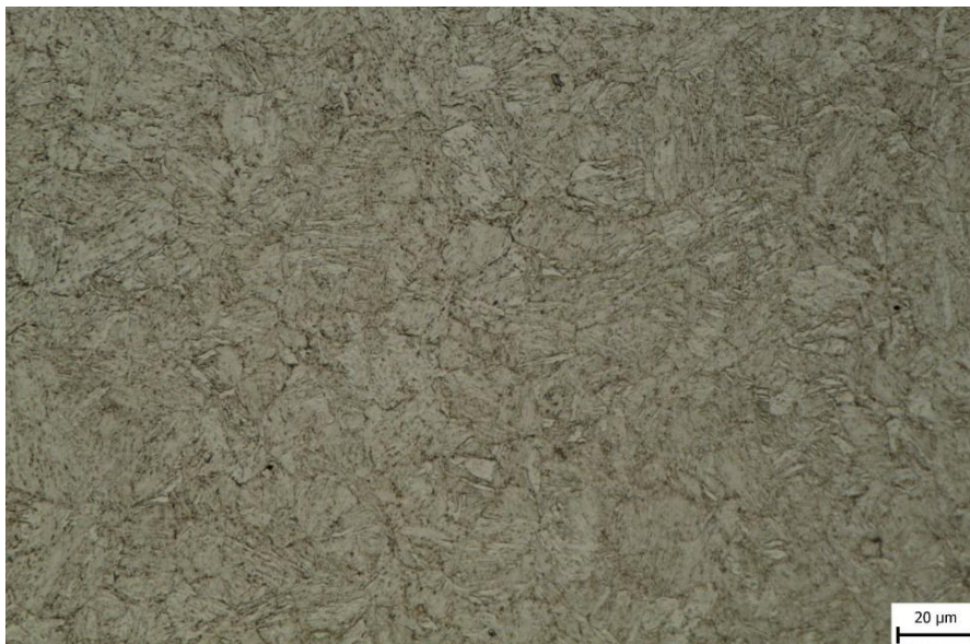
Obr. 72 Mikrostruktura základního materiálu vysokopevnostní oceli IMEX 700 zvětšený 400x.
