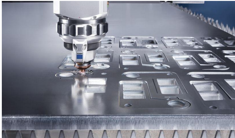
Obr. 17 Dělení materiálu pomocí fibre laseru TRUMPF TruLaser 5030 fiber [4].
