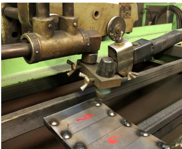
Obr. 42 Vzduchová plazma se zdrojem ESAB LPH 50 využitá při experimentu [53].
