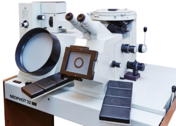
Obr. 69 Schéma optického světelného mikroskopu Zeiss Neophot 32 [54].
