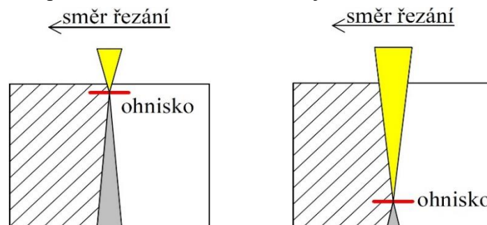
Obr. 19 Poloha ohniska u oxidační metody (vlevo) a tavné metody (vpravo) [32].
