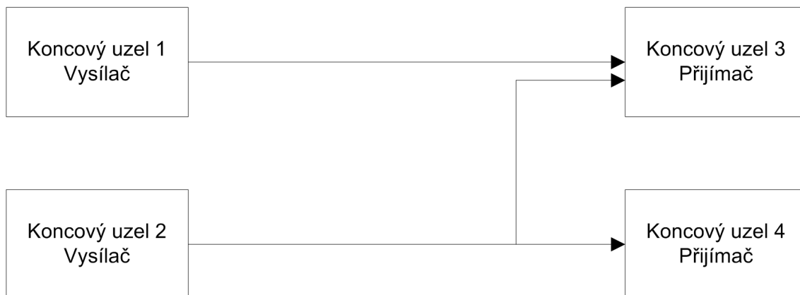
Obr. 2.2: Základní topologie sběrnice ARINC 429.
