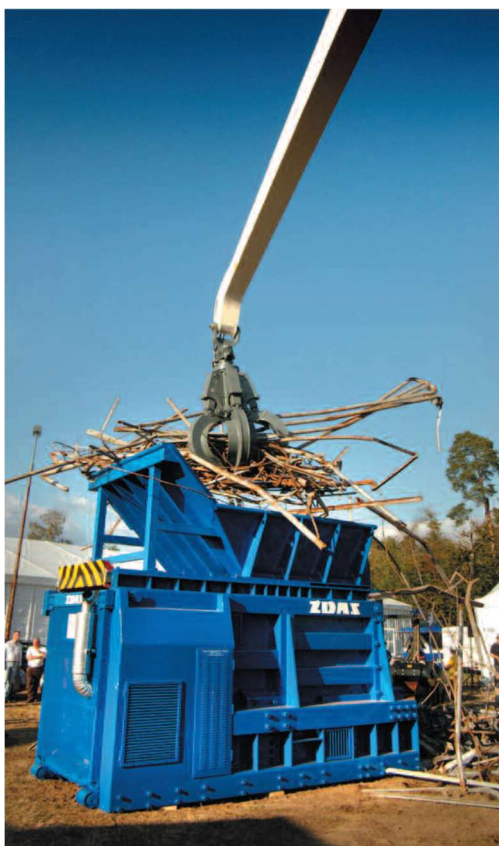
Obrázek 1: Kontejnerové nůžky na šrot CNS 400 K (Zdroj: 1)
