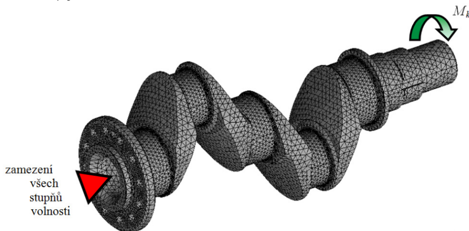
Obr. 61 Schéma zatěžování při určování torzní tuhosti
