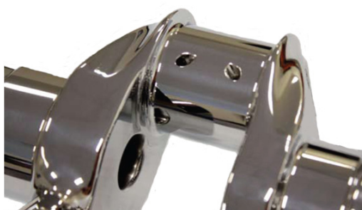
Obr. 25 KH s dutými hlavními i klikovými čepy vozu kategorie NASCAR [18]
