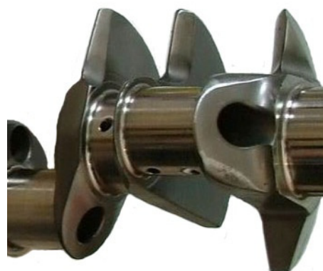
Obr. 35 Dodatečné snížení ventilačních ztrát [29] Obr. 36 Vývažek s jednostranným zkosením [30]
