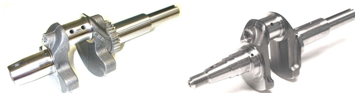
Obr. 6 Porovnání odlévané (vlevo) a kované KH určených pro obdobné motory [9]
