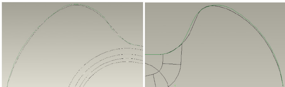
Obr. 42 Změna tvaru záměnou jednoduchých obrysových křivek křivkami typu spline [35]
