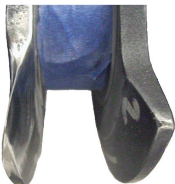
Obr. 35 Dodatečné snížení ventilačních ztrát [29] Obr. 36 Vývažek s jednostranným zkosením [30]
