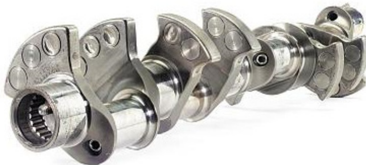
Obr. 33 KH vozu kategorie F1 s axiálními otvory pro vyvažovací tělíska [27]
