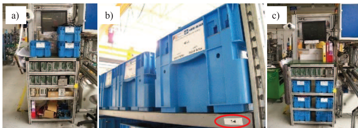
Obr. 5.3 Změny v umístění testovacích kabeláží: a) původní stav regálu na pracovišti, b) nové uspořádání a označení méně využívaných kabeláží v regálech, c) nové umístění kabeláží přímo na pracovišti.
