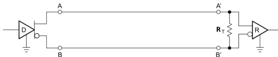
Obrázek 1.6 Linka RS-422 (převzato a upraveno z [23]).
