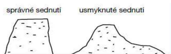
Obrázek 2 – Sednutí kužele po odbednění zkoušky
