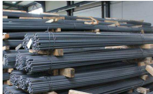
Obrázek 2 – Uložení výztuže ( https://www.betonserver.cz/vyztuz-cz )
