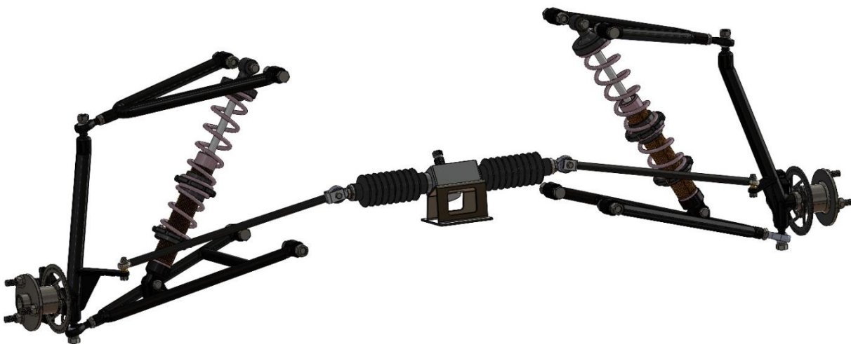
Obr. 19 Přední náprava včetně řízení
