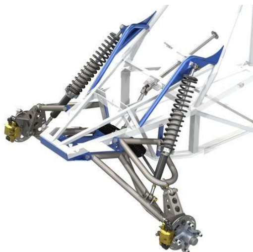
Obr. 3 Lichoběžníkové zavěšení [19]
