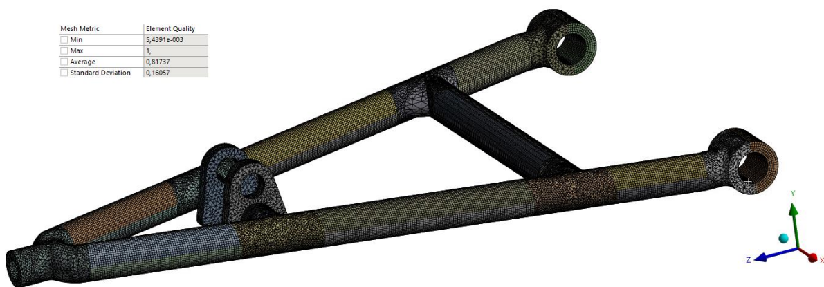
Obr. 42 Vygenerovaná síť spodního ramene s kvalitou sítě
