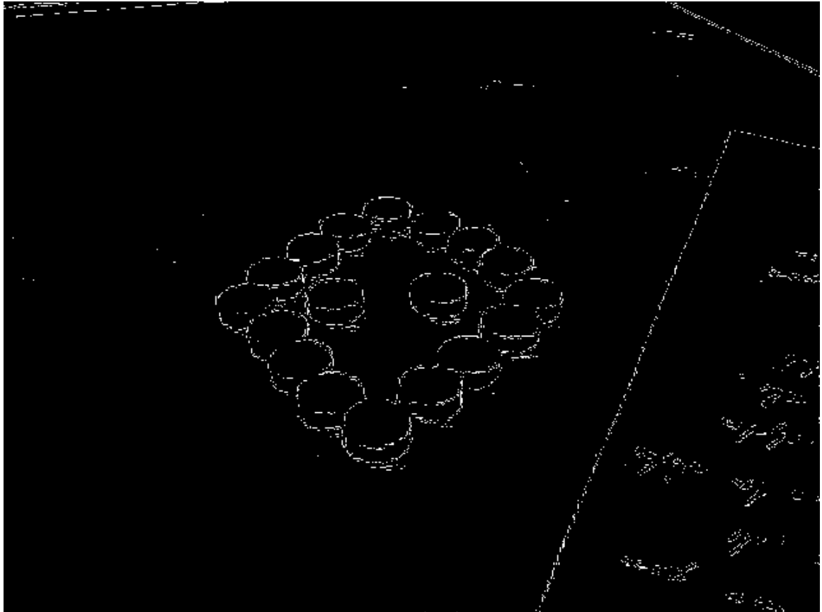
Obr. 6-4 Sobelův detektor hran
