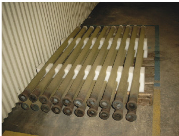
Obr. 2.19 Katalyticky aktivní filtrační svíčky [ 18 ]
