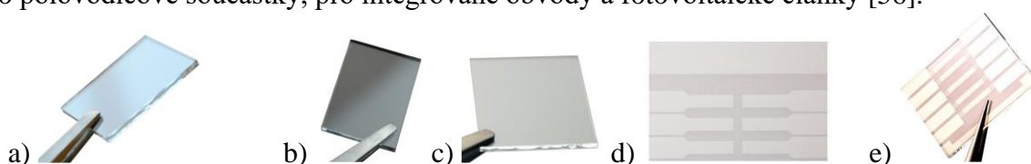
Obr. 9: Skleněný substrát: a) s vrstvou SiO 2 , b) s FTO, ITO skleněný substrát: c) bez vzoru, d) OLED a OPVC, e) OFET
