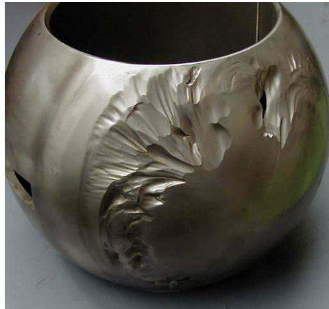
Obr. 11 Erozivní opotřebení kulového uzávěru [6]
