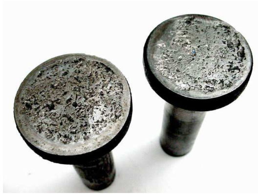
Obr. 13 Únavové porušení zdvihátka ventilu [6]
