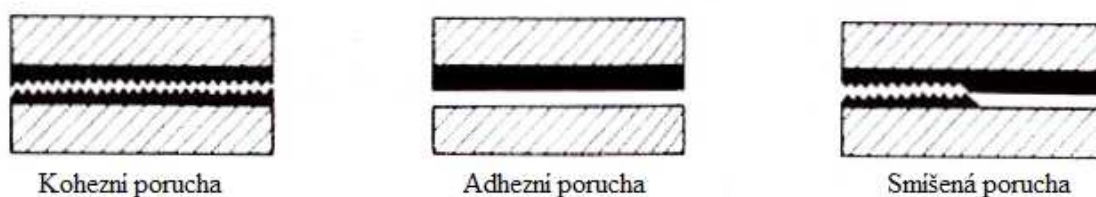
Obr. 24 Druhy porušení lepeného spoje [1]
