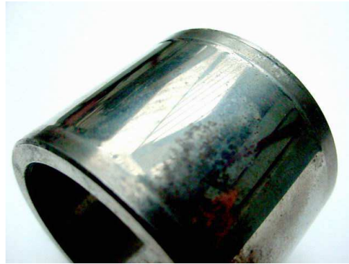
Obr. 8 Adhezivní opotřebení pouzdra - mírné [6]
