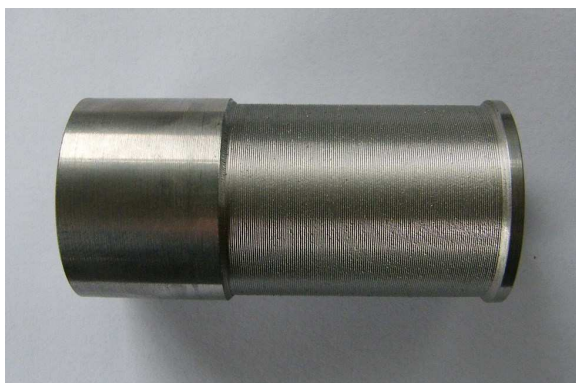
Obr. 39 Připravený povrch soustružením vlevo, vpravo nanášení 1. vrstvy hmoty
