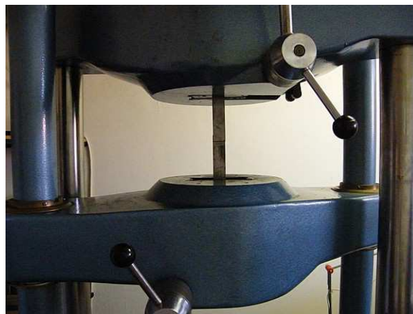
Obr. 33 Zkušební vzorek upevněný v čelistech trhačního stroje
