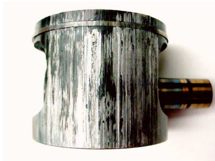
Obr. 10 Abrazivní opotřebení pístu [6]
