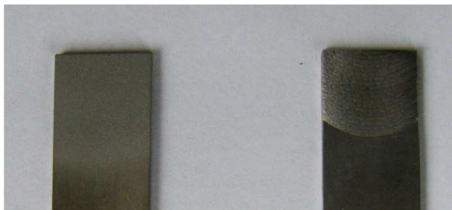
Obr. 29 Povrchy adherendů (vlevo úprava tryskáním, v pravo frézováním)
