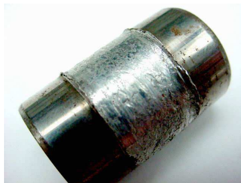
Obr. 9 Adhezivní opotřebení čepu - intenzivní [6]
