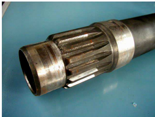
Obr. 14 Vibrační opotřebení drážkování hřídele [6]
