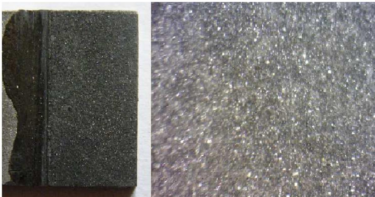
Obr. 36 Detail povrchu kohezní poruchy po smykové zkoušce (světlé body - plniva hmoty), lepené hmotou HRE, tryskaný povrch
