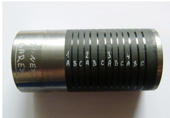
Obr. 43 Zkušební těleso s označením drah opotřebení
