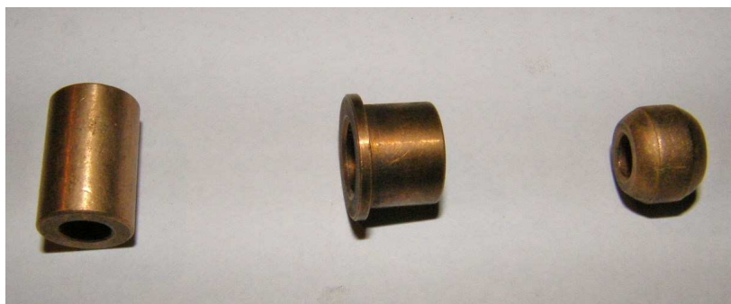
Obr. 18 Různá provedení pevných kluzných pouzder z bronzu
