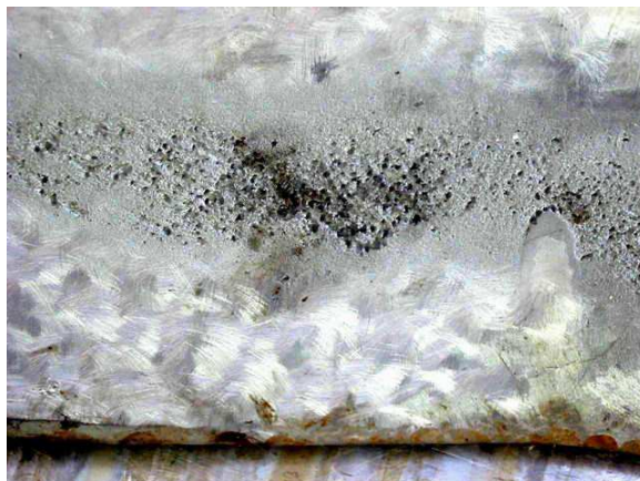
Obr. 12 Kavitační opotřebení rotoru turbíny [6]
