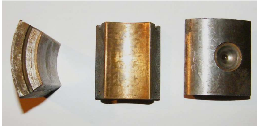
Obr. 16 Ocelové segmenty kluzného ložiska s bronzovou výstelkou
