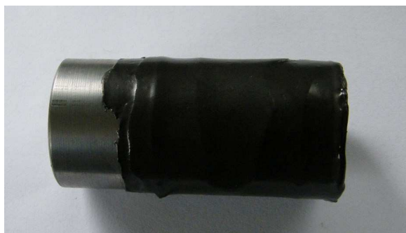
Obr. 40 V levo nanesená hmota s přídavkem, v pravo obrábění vytvrzené hmoty
