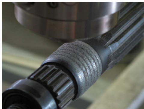
Obr. 5 Laserový návar, přídavný materiál – prášek [44]
