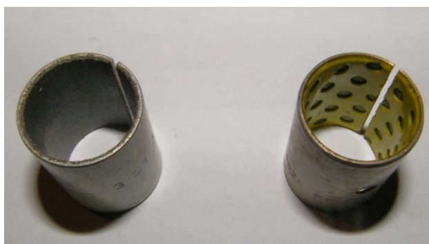
Obr. 19 Skružovaná kluzná ložiska s výstelkou, vlevo PTFE, vpravo POM
