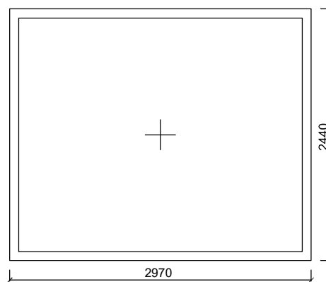
O5 - Okno fixní - čiré - otvor 3000x2500mm 1 kus
