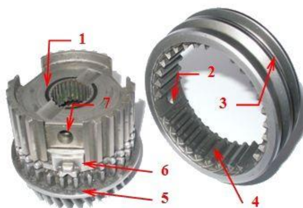
Obr. 1.8 Synchronizační zařízení Peugeot 206: 1- jádro spojky, 2- dosedací plocha pojistné kuličky, 3- drážka pro řadící vidlici, 4- vnitřní ozubení objímky, 5- unášecí ozubení, 6- clonící kroužek, 7- díra pro pojistnou pružinu.
