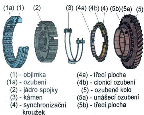
Obr. 1.7 Synchronizační zařízení Borg - Warner [2]
