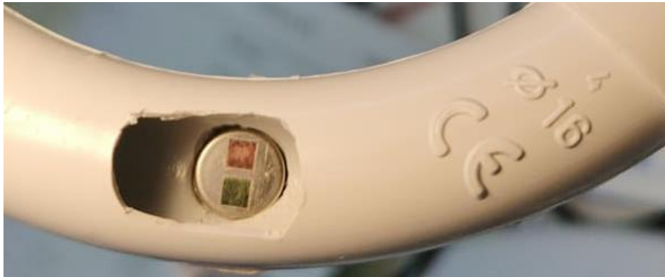
Obr. 8.6: Pohled na dechovou trubicí s detektorem před instalací IR zdroje.
