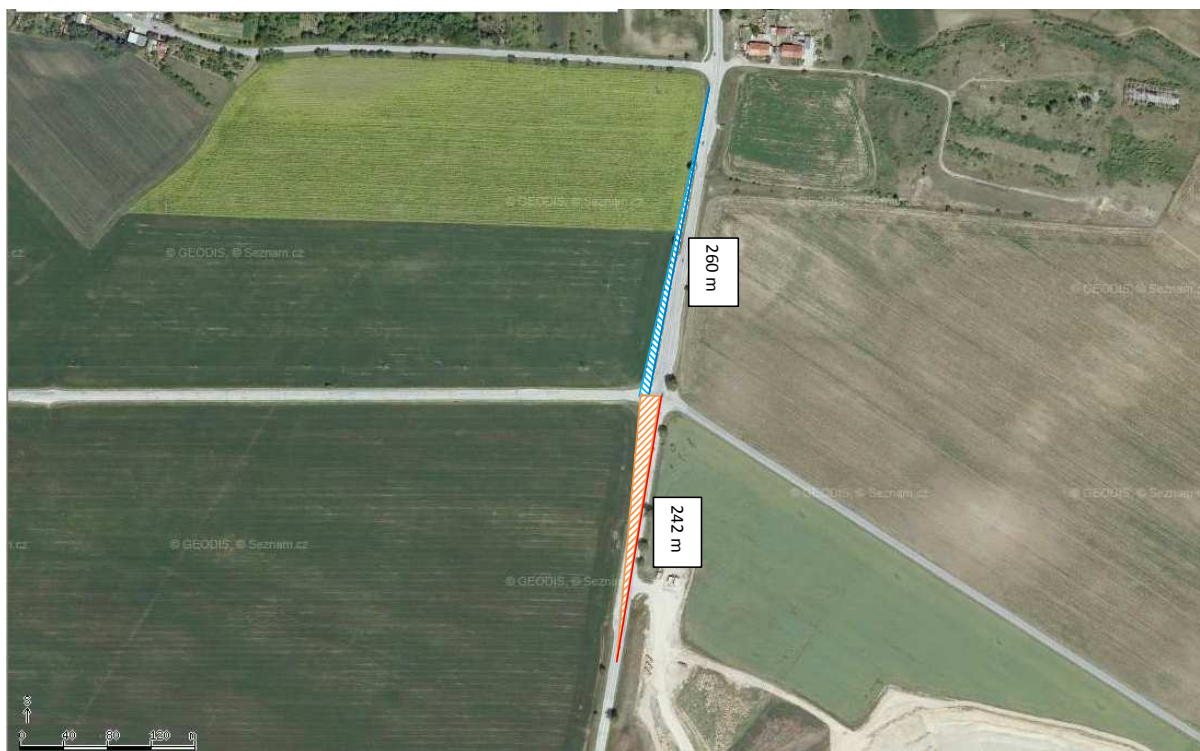
Obr. 50 Rozhledové poměry pro vozidla přijíždějící ze směru od Bratčic – zastavení před spojnicí vodících čar
