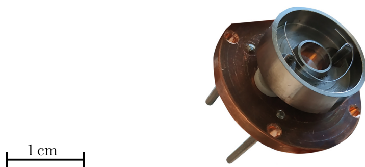
Obrázek 3.3: Wolframové vlákno umístěné ve Wehneltově válci. Foceno při opravě efuzní cely, kdy došlo k přetržení vlákna vlivem teploty.
