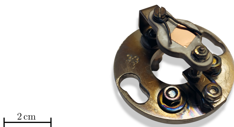
Obrázek 5.1: Nosič vzorků (paletka) do UHV s PBN topným tělískem pro ohřev substrátu. Na paletce je pomocí držáku z nerezového drátu (případně molybdenového plíšku) upevněn substrát pro růst ultratenkých uhlíkových vrstev.
