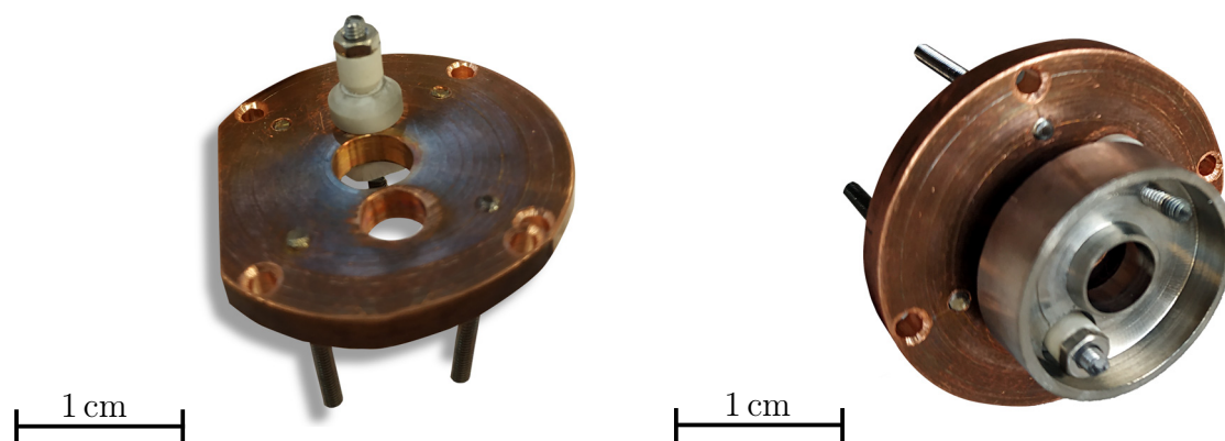
Obrázek 4.2: Konstrukční úprava držáku wolframového vlákna. Vlevo obrázek závitové tyče, na kterou byla umístěna keramická průchodka zamezující zkratu vlákna a Wehneltova válce. Vpravo již Wehneltův válec připevněný ke krytce měděného masivu.
