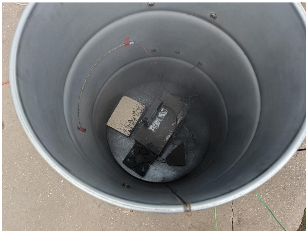
Obrázek 36: Vnitřek sudu po skončení TR
