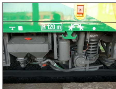
Obr. 1-18 Pískovací zařízení firmy Tribotec KOVA-03D [45]
