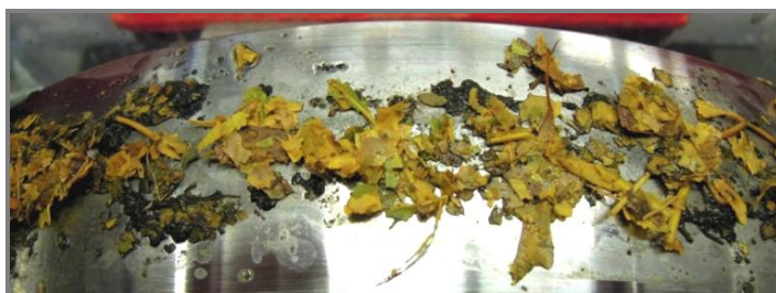
Obr. 4-12 Sm s listy aplikovan  na disk kolejnice
